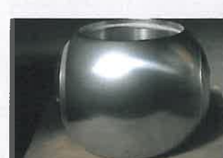
Kugelhähne (ca. 3to) einer Pipelinearmatur hartverchromt.
