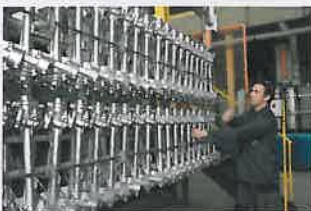
Lenkgehäuse aus Aluminiumdruckguß werden eloxiert und verdichtet.
